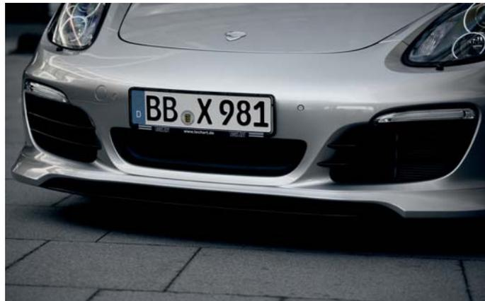
Der zweiteilige Frontspoiler mit integriertem Splitter fügt sich nahtlos in die Designlinie ein.
