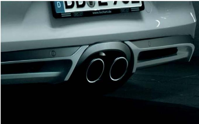
Die Diffusorblende in Wagenfarbe umfasst die Endrohre der Sportabgasanlage.
